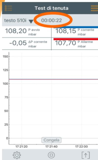
Automaticamente partirà la prova di tenuta.
